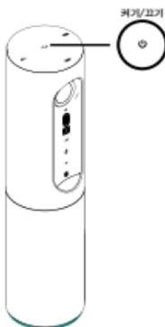
2. 장치를 켜려면 전원 켜기/끄기 버튼을 길게 누르십시오. 사운드가 재생되고, 전원을 켤 때 마지막으로 사용된 모드 LED가 켜진 상태로 장치 LED가 2-3초 동안 켜집니다.
