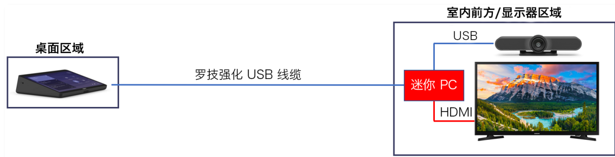
图 4: 罗技小型会议室解决方案 - 安装示意图 - 包含罗技 TP100 和 CC4000e
